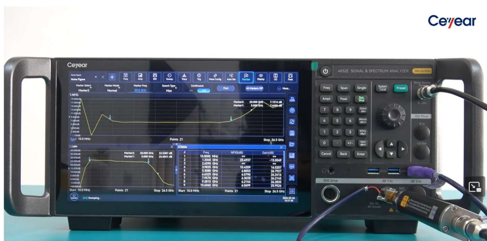
Рисунок 13. Перегляд результатів вимірювання коефіцієнта шуму з можливістю маркерних вимірювань
