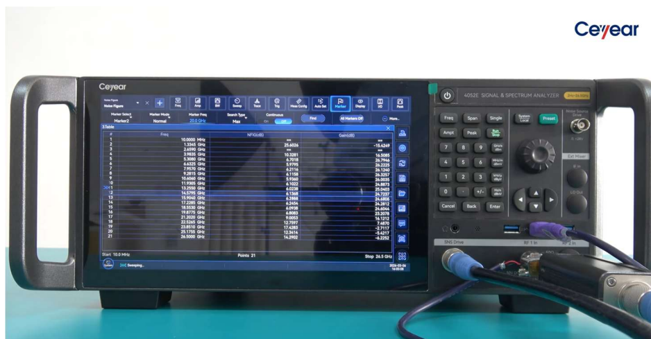
Рисунок 4. Автоматичне обчислення коефіцієнта шуму та коефіцієнта підсилення методом Y-фактора.
