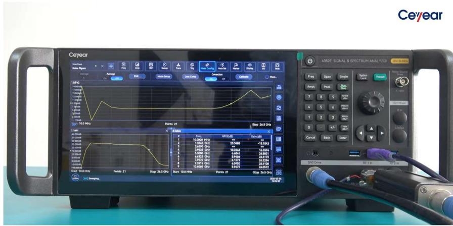
Рисунок 7. Типова схема підключення досліджуваного пристрою (DUT) для вимірювання коефіцієнта шуму.
