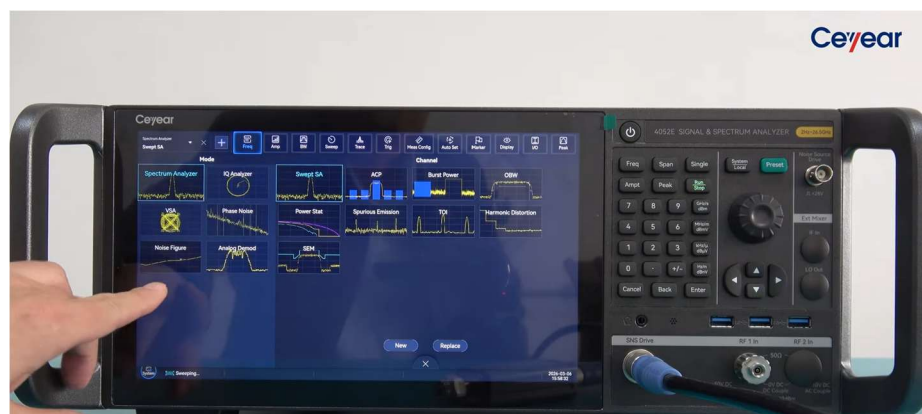
Рисунок 5. Аналізатор сигналів і спектра Ceyear 4052/4082, який використовується для вимірювання коефіцієнта шуму.
